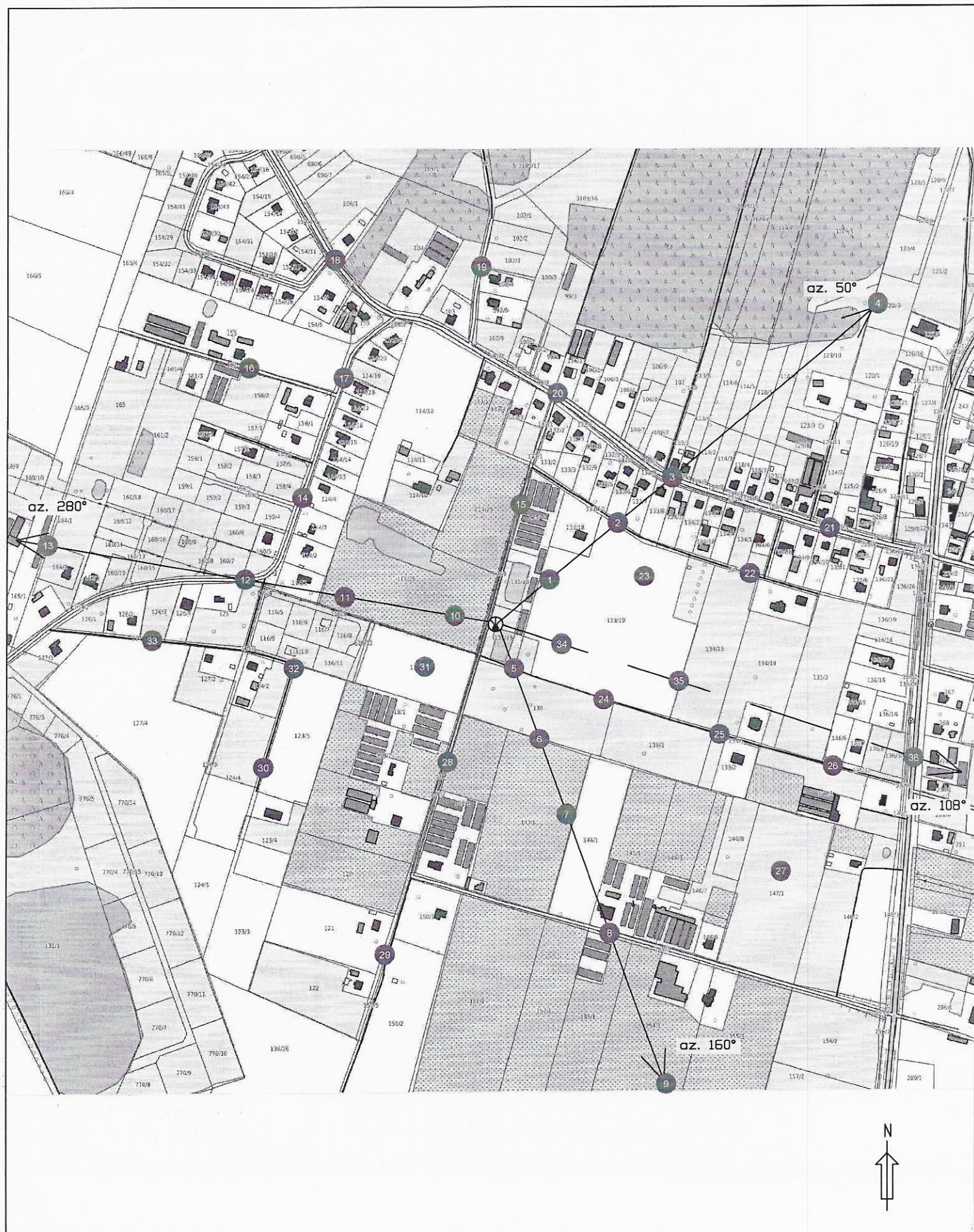
Rys.1 Lokalizacja pionów pomiarowych
